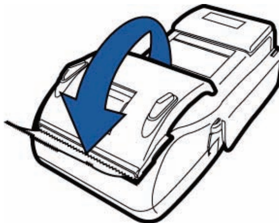
Рис. 11 Закрытие крышки отсека для бумаги
