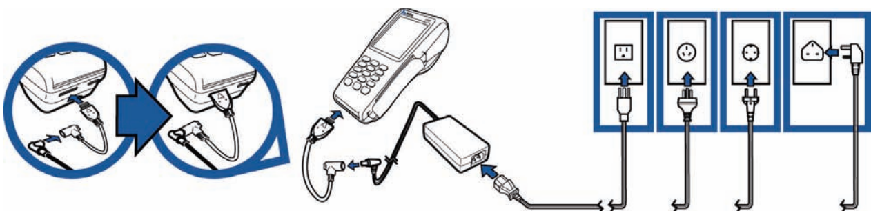
Рис. 22 Подключение блока питания к терминалу VX 680
