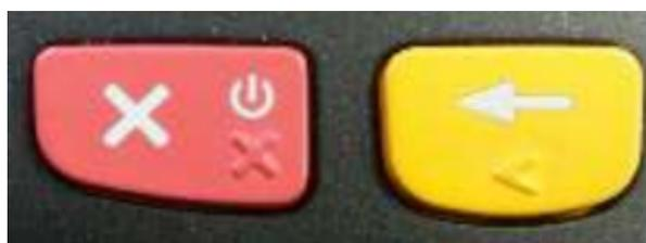
Затем выключаем аппарат, зажимаем желтую кнопку и не отпуская её нажимаем красную. На экране терминала появится надпись - «Prolin OS update» и начнется обновление.
