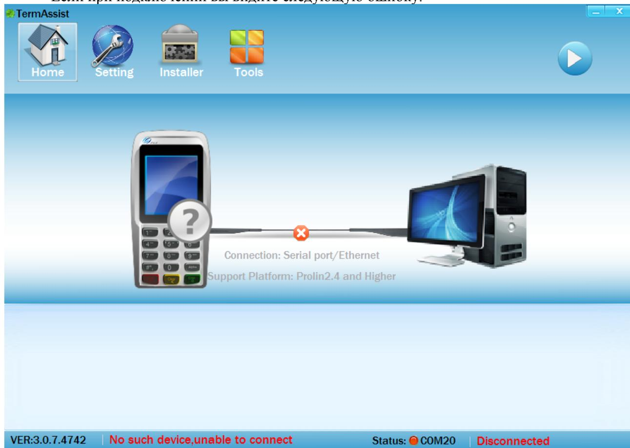
В первую очередь необходимо переподключить кабель miniUSB, а затем проверить включен ли на устройстве XCB service как USB(смотри 3. Предварительная настройка.)
