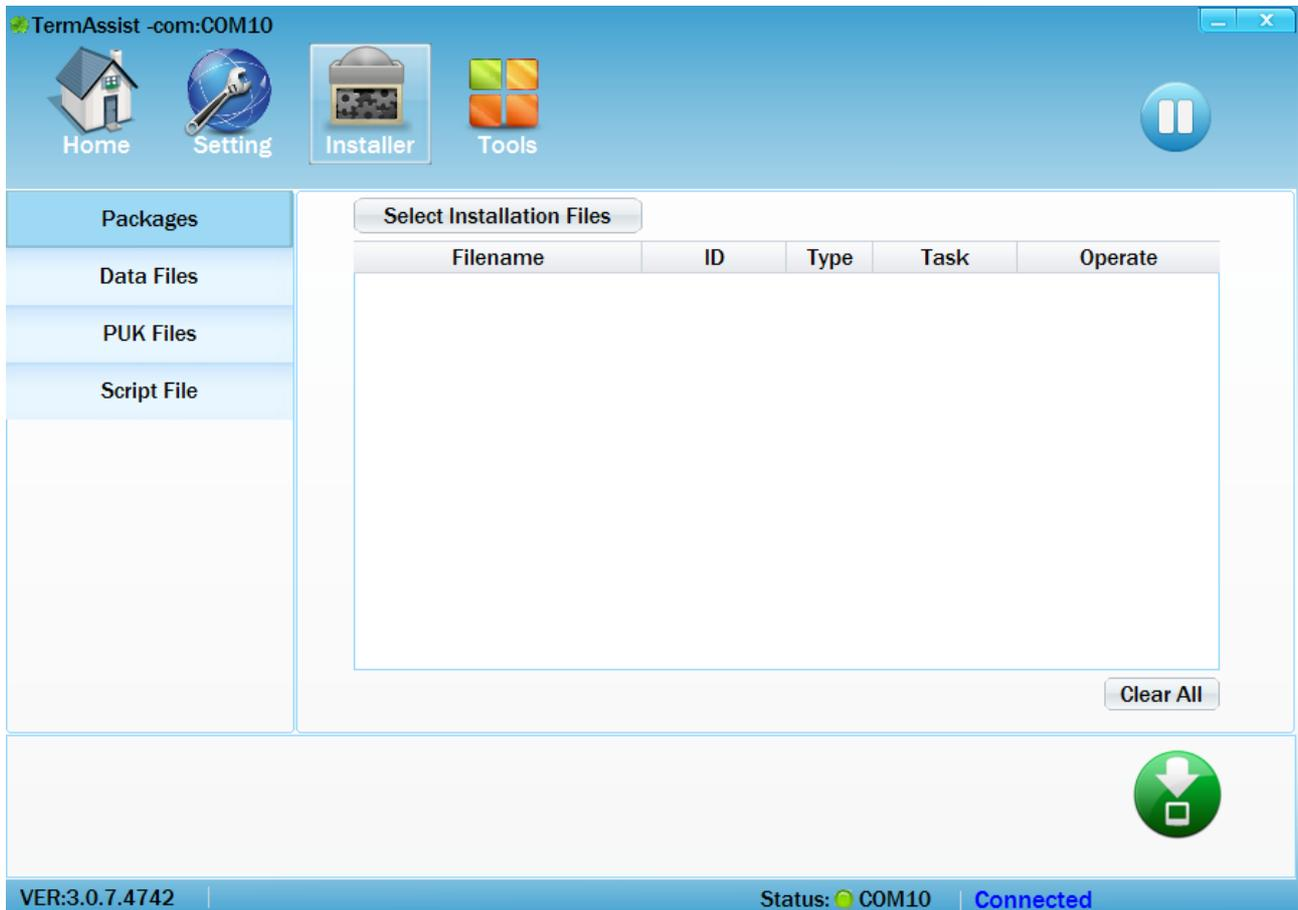
В левой части экрана выбрана вкладка Packages, она используется для загрузки ПО в кассу. Нажимаем кнопку Select Installation Files, выбираем файл с новой версией программы.
