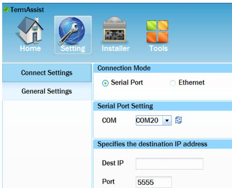
Открыть вкладку Settings, в разделе Serial Port Settings выбрать COM порт, к которому подключен аппарат и нажать
