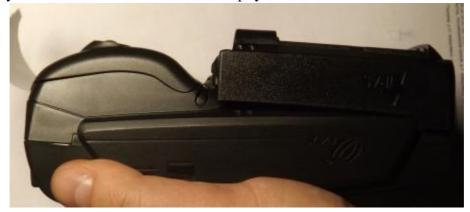
6. Придерживая фискальный блок в приподнятом положении, надавите на торец фискального блока или нанесите по торцу фискального блока легкий удар, например, прорезиненной ручкой отвертки. После разделения блока и S900 аккуратно положите на стол терминал и отсоединенный фискальный блок.
