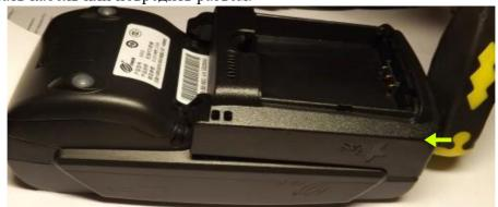
7. Открутите винт, прикрепляющий плату фискального регистратора к корпусу фискального блока, выньте плату из блока.
